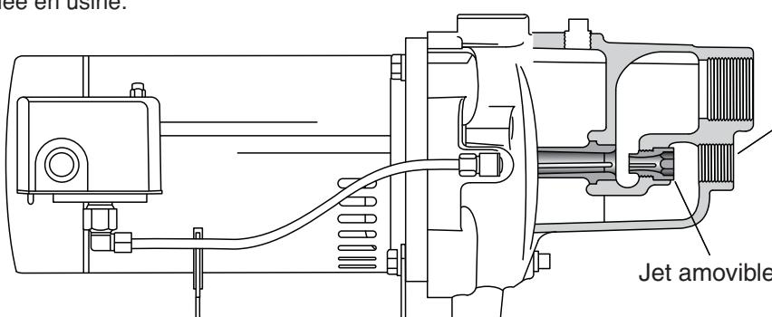
3. Installez la buse à jet souhaitée pour modifier la performance de la pompe. Resserrez la nouvelle buse à jet à 40 po-lb.
