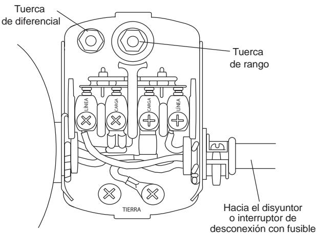
El interruptor de presión está configurado para dar arranque a la bomba a 30 psi y para detenerla a 50 psi. **EL INTERRUPTOR DE PRESIÓN NO REQUIERE AJUSTES EN UNA INSTALACIÓN NORMAL DE BOMBA.** Ajuste el interruptor sólo si resulta necesario y siguiendo el procedimiento a continuación:
