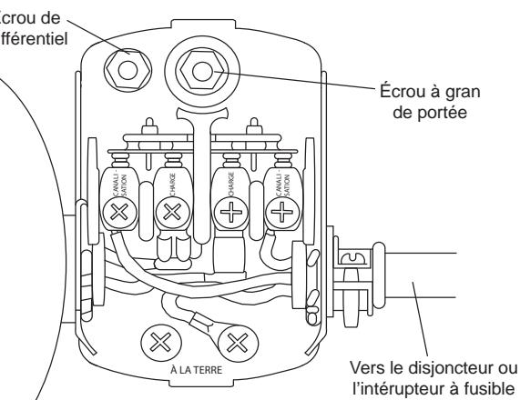
Le manostat est réglé pour démarrer la pompe à 30 psi et pour s'arrêter à 50 psi. **LE MANOSTAT NE DEVRAIT PAS NÉCESSITER DE RÉGLAGE POUR L'INSTALLATION TYPE DE LA POMPE.** Réglez le manocontacteur seulement au besoin en suivant les étapes suivantes :
