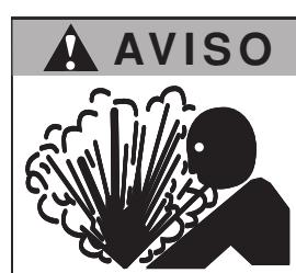
**! AVISO PRESIÓN PELIGROSA:** No haga funcionar la bomba contra una salida cerrada. Libere todos los sistemas de presión antes de trabajar en cualquier componente.
