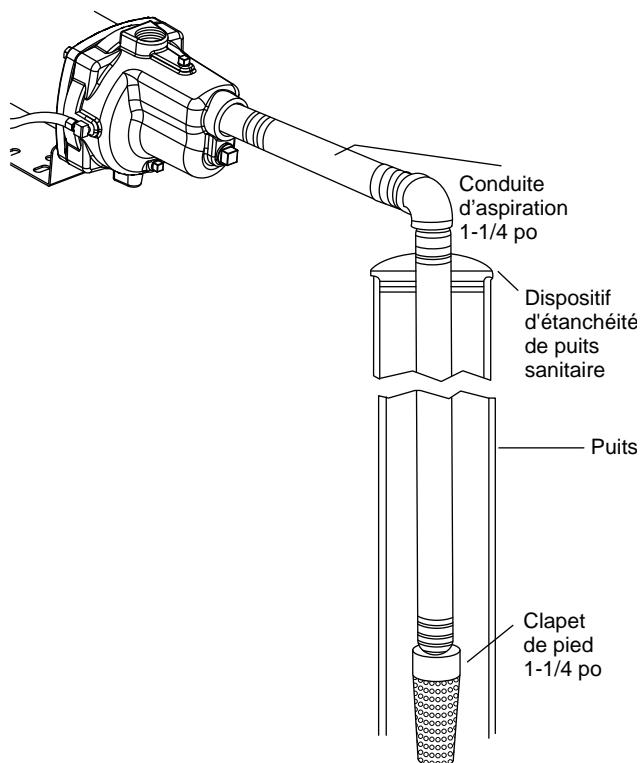
puits tubé/ordinaire. Peut être utilisé soir pour le pompage depuis un lac ou un ruisseau, à condition que l'extrémité de la conduite d'aspiration soit également protégée par une crépine. Il faut bien s'assurer que tous les raccords d'aspirations soient serrés et étanches. Sinon, la pompe ne peut être amorcée ou perdra son amorçage sur une certaine période de temps.
