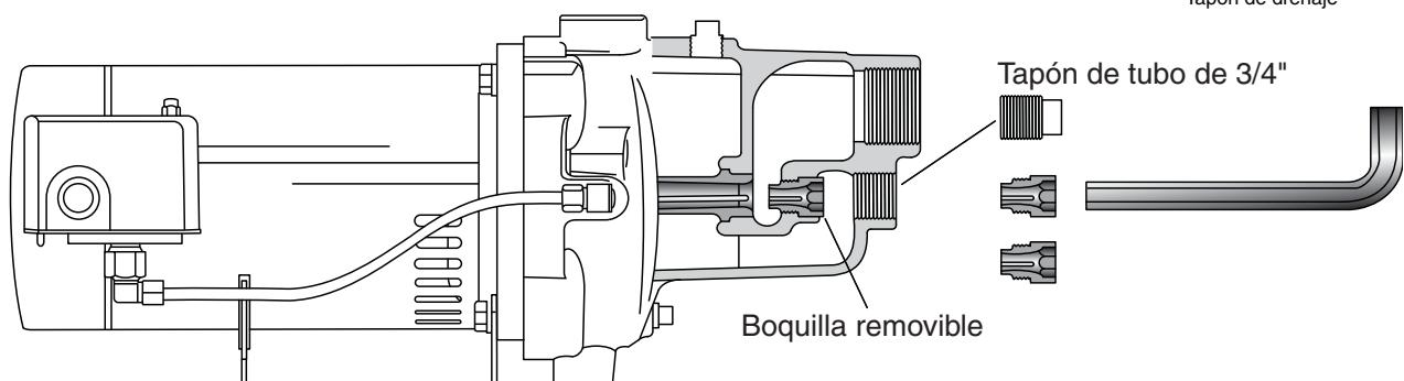
**AVISO:** Aunque este proceso drene la bomba, no necesariamente drenará las demás partes de la tubería. Si existe alguna preocupación sobre el procedimiento adecuado o necesidad de drenar la tubería de succión, entre en contacto con su contratista.
